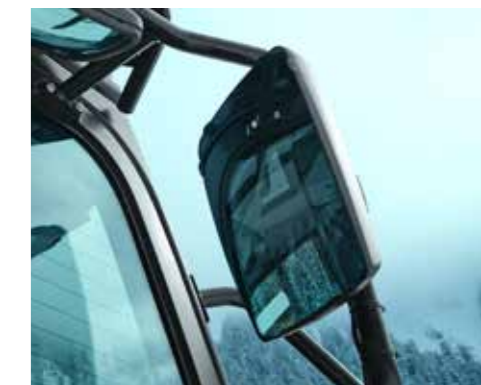
Specchietti retrovisori esterni a regolazione elettrica.
