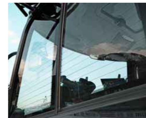
Finestrini laterali a doppio scorrimento e riscaldabili in qualsiasi posizione per un'ottima visuale laterale.
