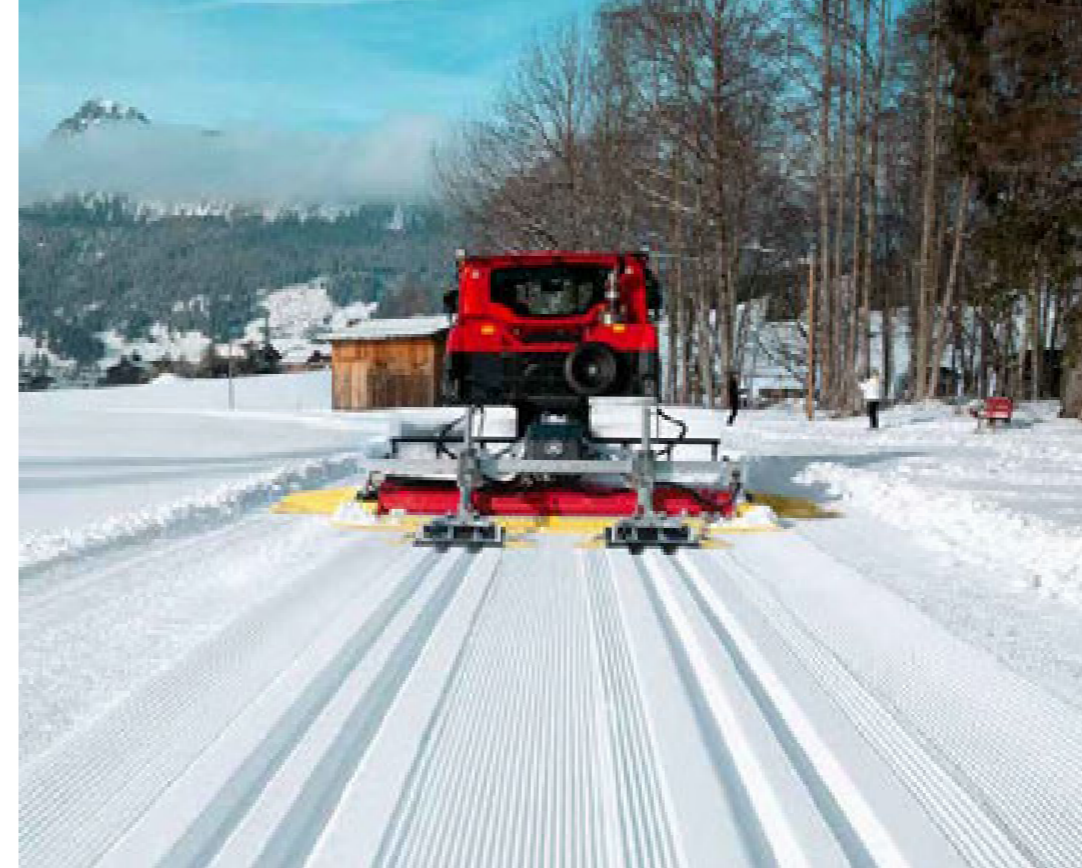
Tracciatore da fondo doppio a regolazione meccanica Tracciatore da fondo doppio con spostamento laterale idraulico piastra tracciatore
