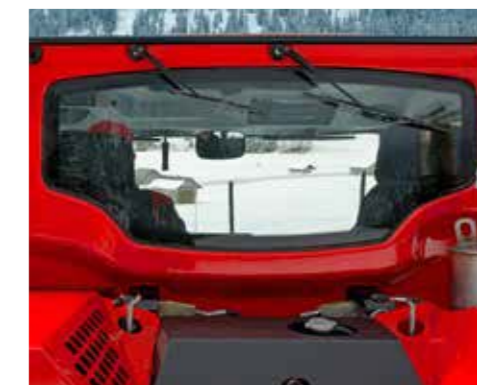
Lunotto ampliato e riscaldato per un'ottima visuale anche posteriormente.
