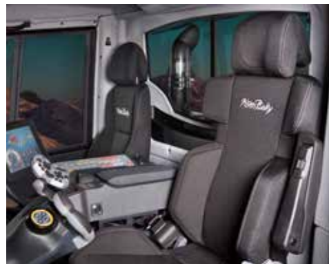
Nuovo sedile ergonomico con sostegno laterale migliorato, tante possibilità di regolazione e riscaldamento.
