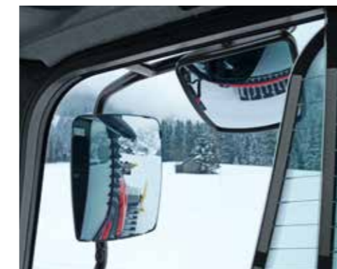
Gli specchi d'accostamento a largo campo visivo assicurano la visuale diretta sui cingoli.
