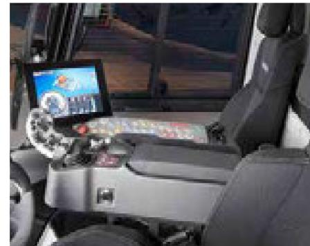
Optimierte Bedienung auch bei unruhigem Untergrund durch die mit dem Sitz verbundene Steuereinheit.
