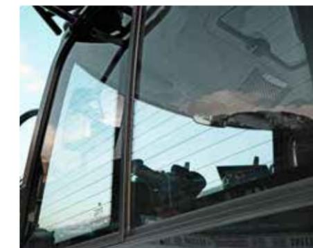
Doppelt verschiebbare und in jeder Position beheizbare Seitenscheiben für seitlich optimale Sicht.
