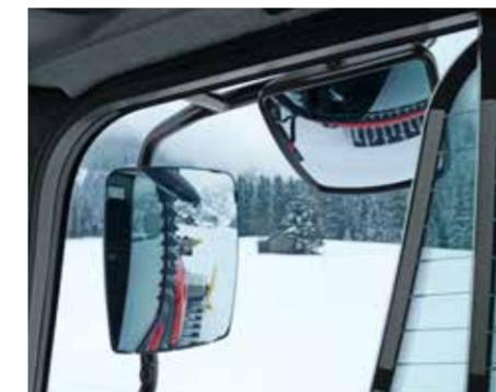
Rampenspiegel sorgen für direkte Sicht auf die Ketten.
