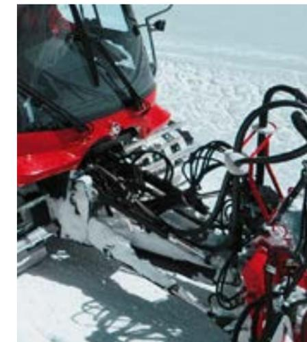
Der PistenBully kann durch einen zusätzlichen Hochdruckanschluss an der Front des Fahrzeuges um weitere hydraulisch angetriebene Zusatzgeräte wie die Frontfrässhleuder ergänzt werden.
