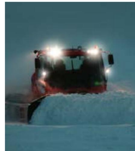
Das Lichtkonzept des PistenBully ist bestens auf die Einsatzanforderungen ausgerichtet: Ein umfangreiches LED-Lichtpaket mit leistungsstarken Arbeitsscheinwerfern, auch an den Spiegelhalterungen, sowie Treeline-Leuchten, sorgen für optimale Ausleuchtung der Arbeitsbereiche vorne und hinten, der Kette und der seitlichen Pistenabschnitte.
