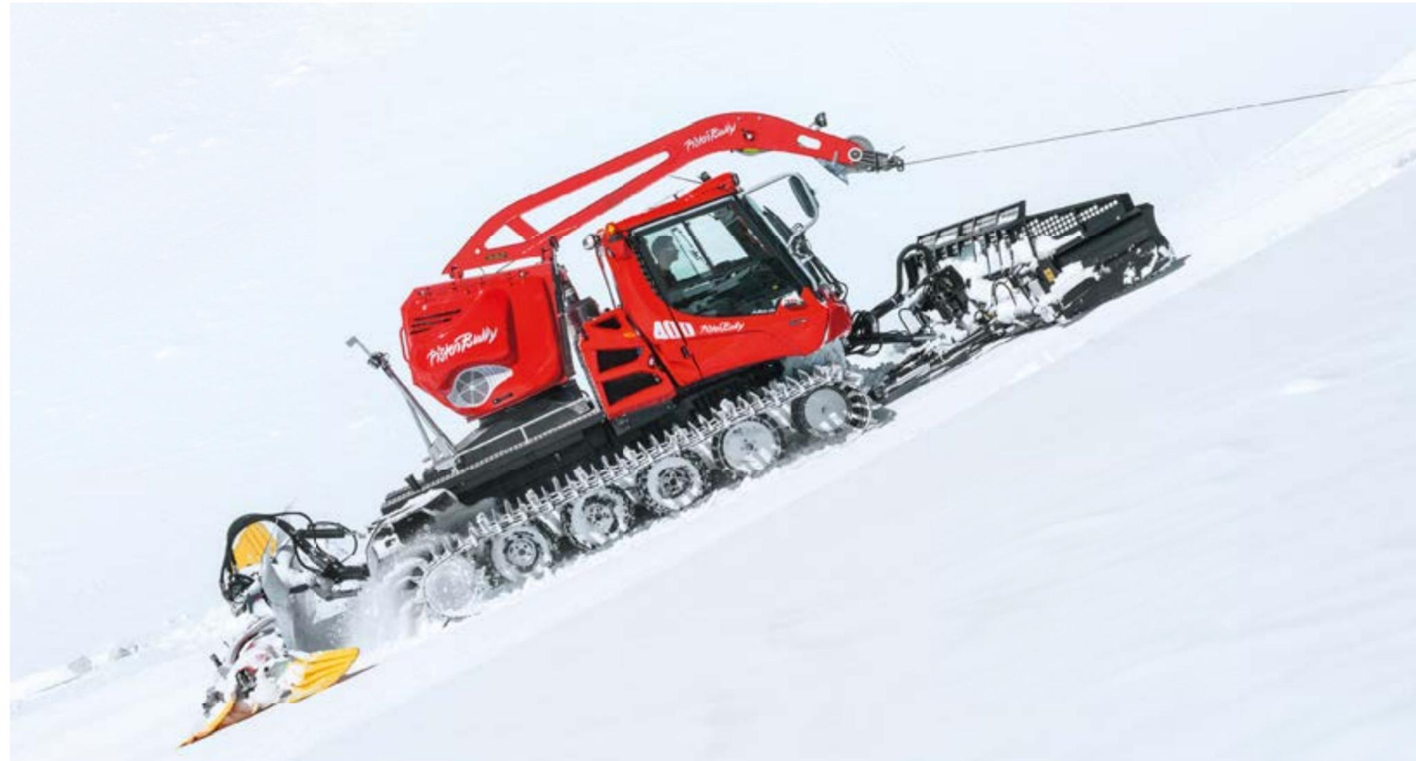
Für jede Situation im Nordic-Sport gut gerüstet – von Neuschnee bis hin zu hart vereisten Oberflächen. Dank des ausgeklügelten Frässystems zieht man in nur einem Arbeitsgang Loipenspuren, die den Anforderungen der FIS entsprechen.
