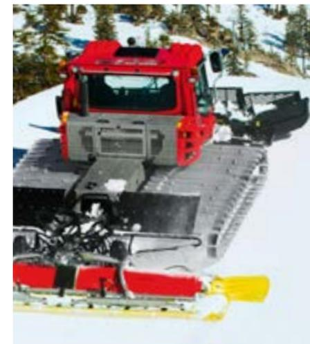
Durch die schmale Plattform hat man die Alpin-FlexFräse jederzeit perfekt im Blick. Dies erlaubt noch präziseres Arbeiten mit der Fräse hinsichtlich Drehzahl, Fräshöhe und aktuell verarbeiteter Schneemenge. Auch im Park ist die schmale Plattform für viele Shaper ein Muss. Denn aufgrund der uneingeschränkten Sicht kann man genau sehen, wann die Fräse abgesenkt werden muss, um eine perfekte Oberfläche auf dem Feature zu hinterlassen.
