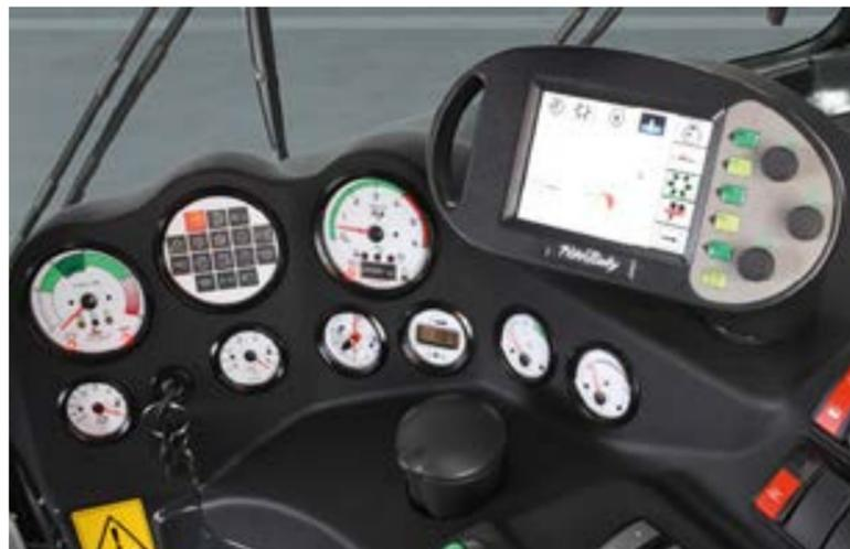
Die On-Board-Diagnose kann vom Fahrer direkt über den Touchscreen aufgerufen werden. Mithilfe des schnellen PSX-Leitrechners lassen sich alle Funktionen zentral steuern. So können Sie schnell und effektiv Kennzahlen des Leistungs- und Energiemanagements, des Motors, der Hydraulik und der Fahr- und Fräspumpen aufrufen, überwachen und auswerten.
