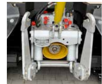
Heck-3-Punkt Kraftheber Kat. 2 inkl. Gelenkwelle 1 3/8 6-Kant Profil (auch als Front-3-Punkt Kraftheber)
