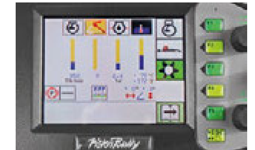
I sensori di inclinazione integrati mostrano la posizione della lama e del veicolo in tempo reale.
