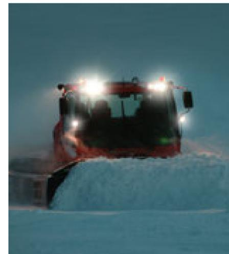
L'éclairage du PistenBully est conçu pour répondre aux contraintes spécifiques aux conditions d'emploi du véhicule : avec ses projecteurs de travail puissants, y compris sur les supports de rétroviseurs, ainsi que les feux Treeline, l'ensemble du système d'éclairage LED garantit une visibilité optimale des zones de travail avant et arrière, de la chenille et des parties latérales de la piste.
