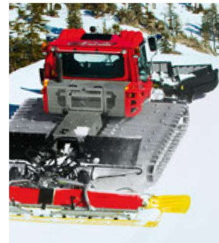
Grâce à la plate-forme au plateau étroit, la fraise AlpinFlex reste sous contrôle en permanence, ce qui permet de travailler avec encore plus de précision en termes de régime, de hauteur de fraissage et de quantité de neige préparée. Ce plateau est également un must pour de nombreux shapers de snowparks : la visibilité parfaite qu'il offre permet de déterminer le moment opportun pour faire descendre la fraise afin de préparer le module de façon impeccable.
