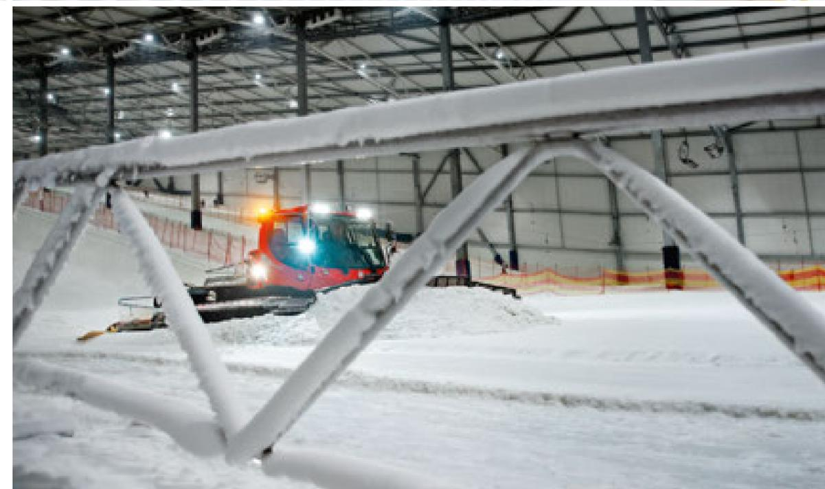
Conçu pour répondre à toutes les exigences de la pratique des sports nordiques et pour tous les types de neige, de la plus fraîche à la plus verglacée. Le système de double fraise permet de préparer en un seul passage une piste de fond conforme aux standards de la FIS.
