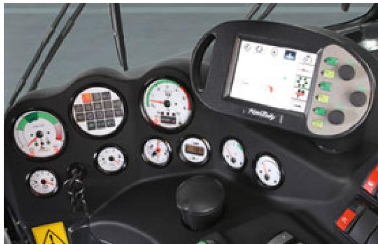
Le conducteur peut consulter directement le diagnostic embarqué via l'écran tactile. Avec l'aide de l'unité de contrôle PSX, toutes les fonctions peuvent être commandées de manière centrale. Ainsi, vous pouvez consulter, contrôler et analyser rapidement et efficacement les caractéristiques de la gestion de puissance et d'énergie, du moteur et de l'hydraulique, des pompes de marche et de fraise.
