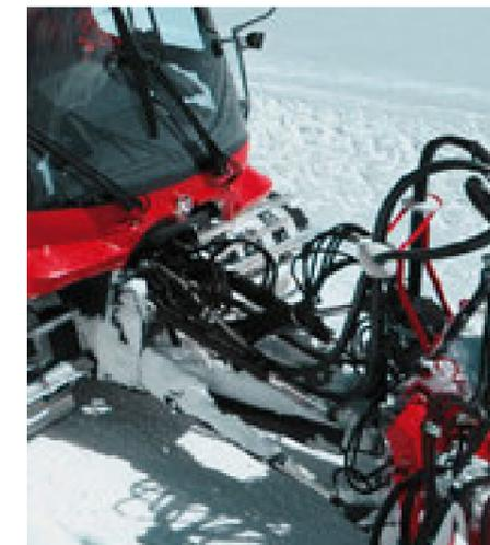
Grâce à sa connexion frontale haute pression supplémentaire, le PistenBully peut accueillir d'autres accessoires entraînés hydrauliquement tel qu'une turbo fraise.
