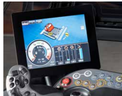
iTerminal breveté encore plus convivial grâce à la mise en évidence en couleur des parties actives de la dameuse.
