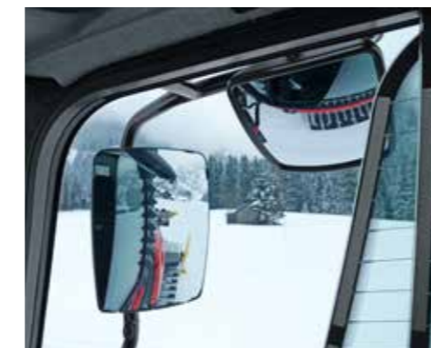
Les rétroviseurs d'angle procurent une vue directe sur les chenilles.
