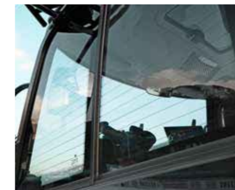
Les vitres latérales doublement coulissantes et dégivrantes dans toutes les positions offrent une visibilité latérale optimale.
