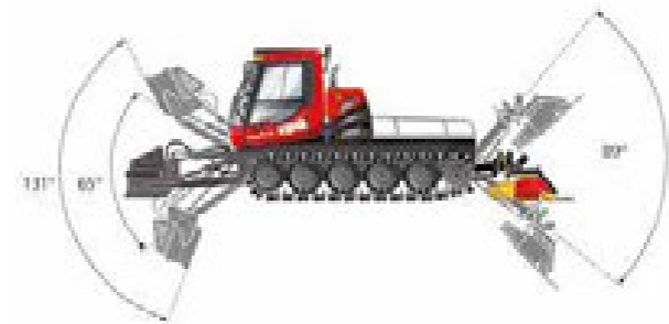
Maniabilité extrême des accessoires avant et arrière pour un façonnage et refaçonnage parfaits.
