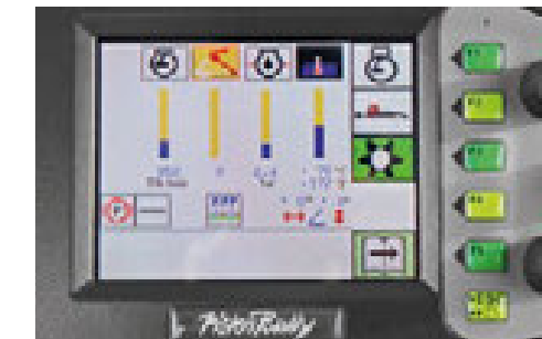
Capteurs d'inclinaison intégrés indiquant la position instantanée de la lame et du véhicule.
