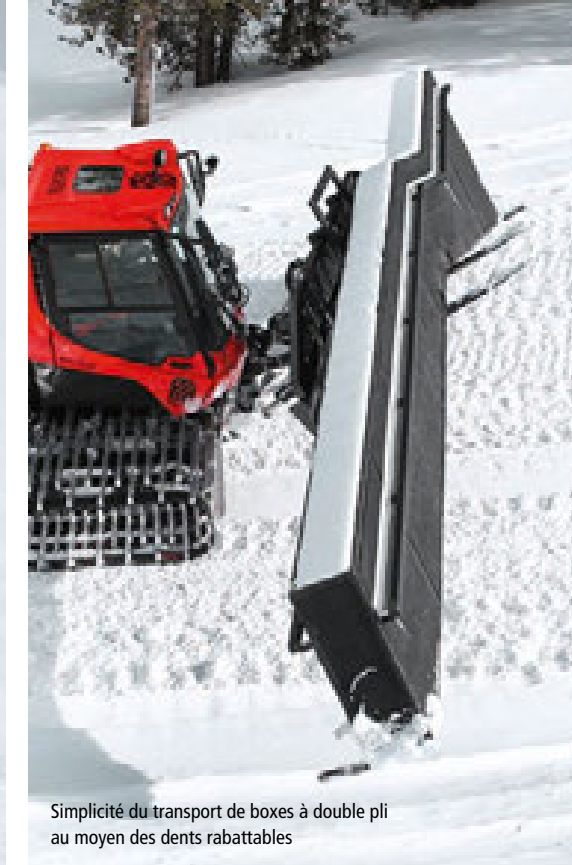
La SwitchBlade 2 est conçue de façon que l'énergie soit répartie de manière régulière sur tout le châssis lorsque le véhicule pousse la neige. Pour une stabilité et une puissance de poussée maximales.
