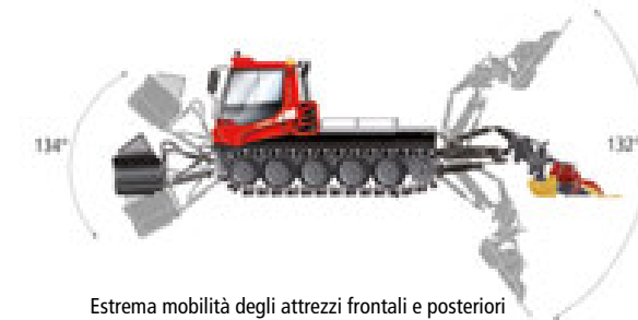
Estrema mobilità degli attrezzi frontali e posteriori per un perfetto shaping e reshaping
