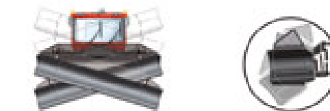
La massima flessibilità della lama sgombraneve a 12 vie consente di modellare con precisione forme particolari.
