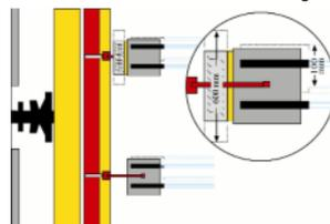
Distanza tra i corpi traccianti: 260 - 360 mm (regolabile elettricamente)
