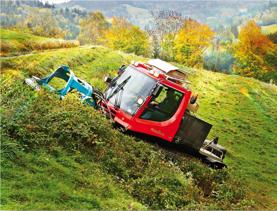
Illustration 3 : photo du PistenBully GreenTech en train de faucher
