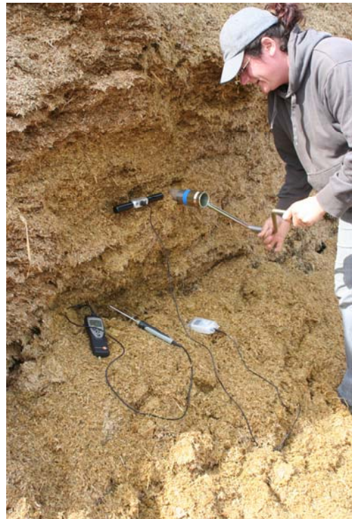
Abbildung 6: Probenahme (links) und Temperaturmessungen in den Bohrlöchern (rechts)
