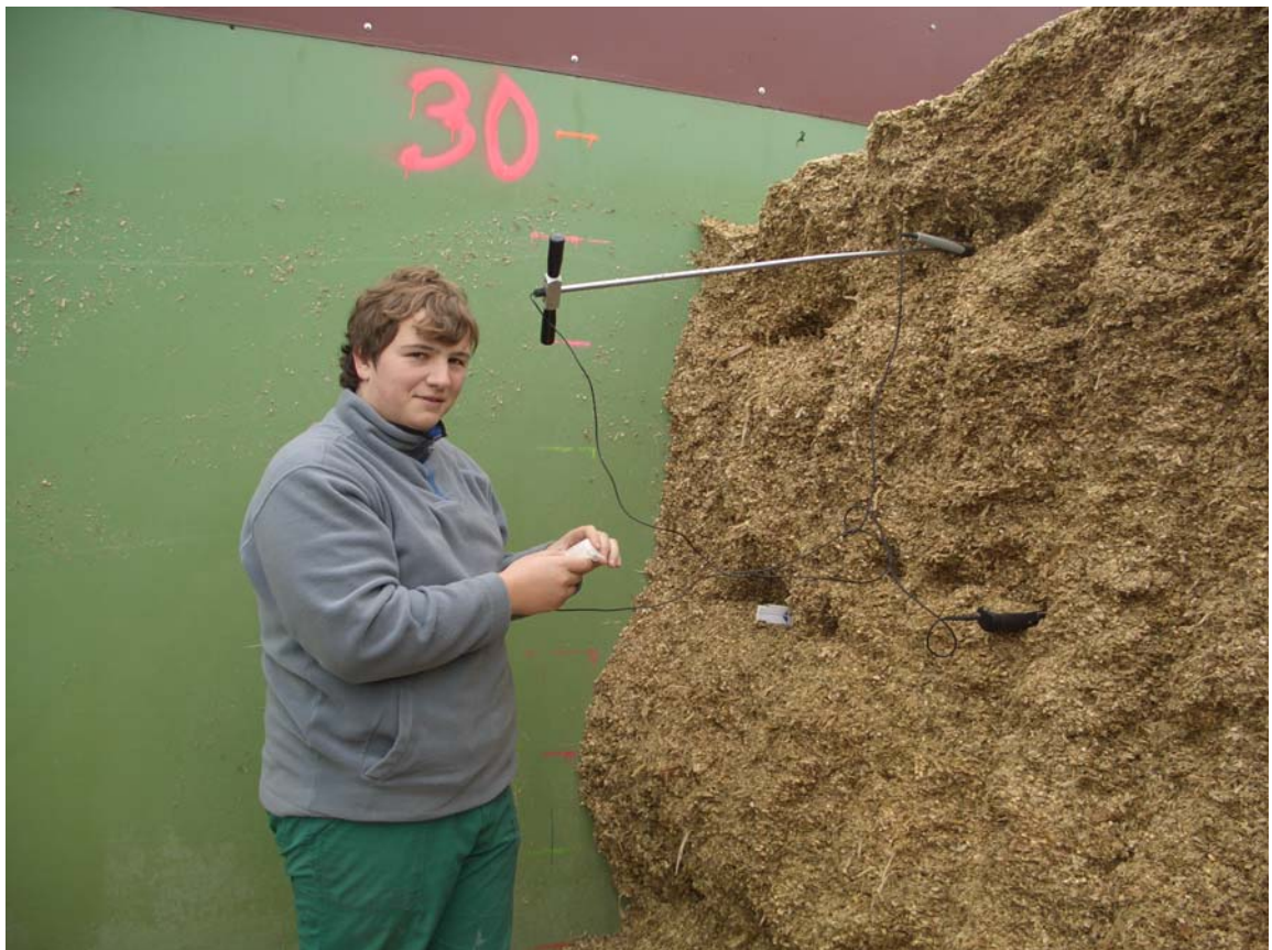
Abbildung 2: Temperaturmessungen in den Bohrlöchern
